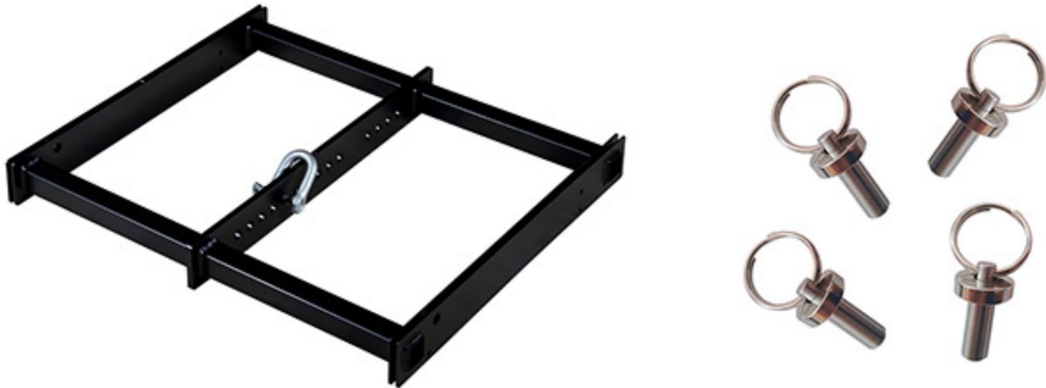
Hardware de vuelo para GT 118 B compuesto por: un marco de acero ligero + cuatro pinlock + un grillete para soportar un peso máximo de una tonelada y media. Permite elevar hasta un total de 16 unidades del GT 118 B.
