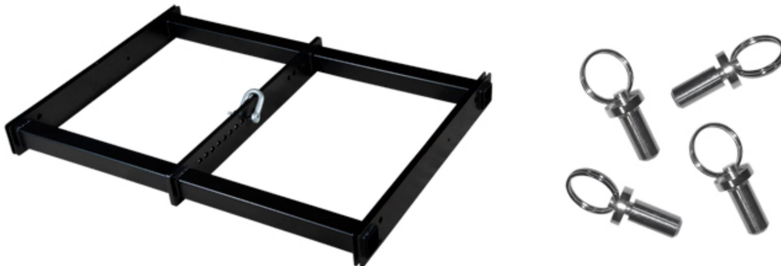
**Hardware de vuelo para GT 218 B** compuesto por: un marco de acero ligero + cuatro pinlock + un grillete para soportar un peso máximo de dos toneladas. Permite elevar hasta un total de 16 unidades del GT 218 B.
