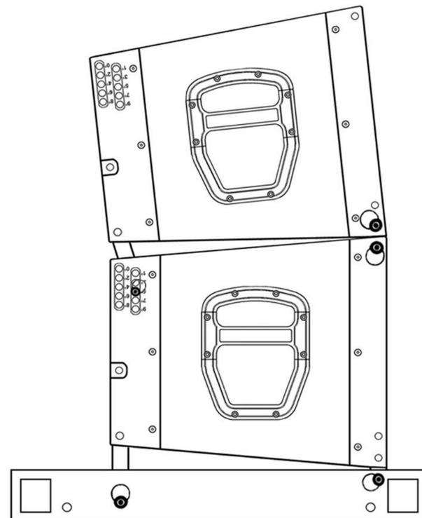
Modo estacado para la máxima versatilidad y cobertura / Stack mode for offer the maximum versatility and coverage.
